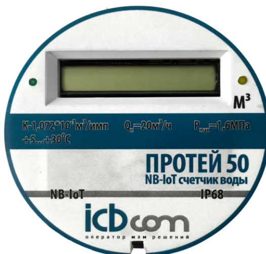
Рисунок 1 – Модуль NB-IoT (НИС-В) для счетчика воды Протей
